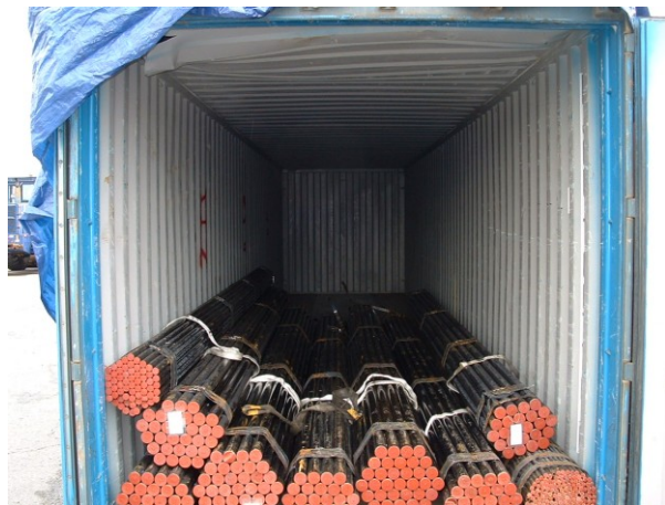
Gráfico 2.3. Haces de tubos de acero sujetos de forma inadecuada
