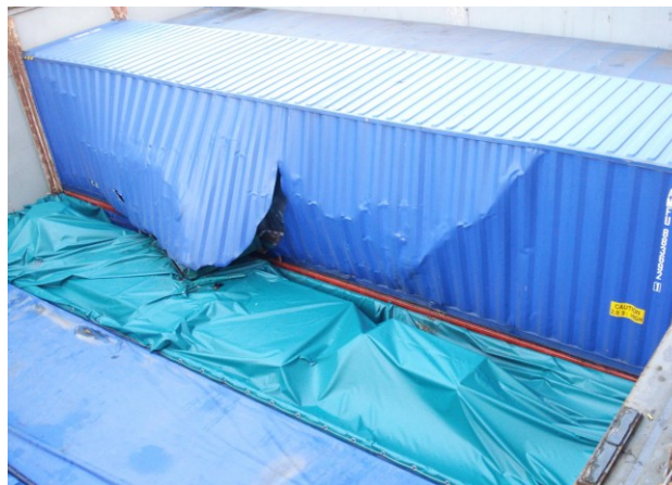
Gráfico 2.5. Pared lateral dañada
