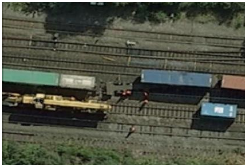
Gráfico 1.8. Descarrilamiento de vagones de contenedores
