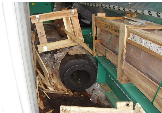
Gráfico 4.2. Dispositivos de bloqueo sueltos
