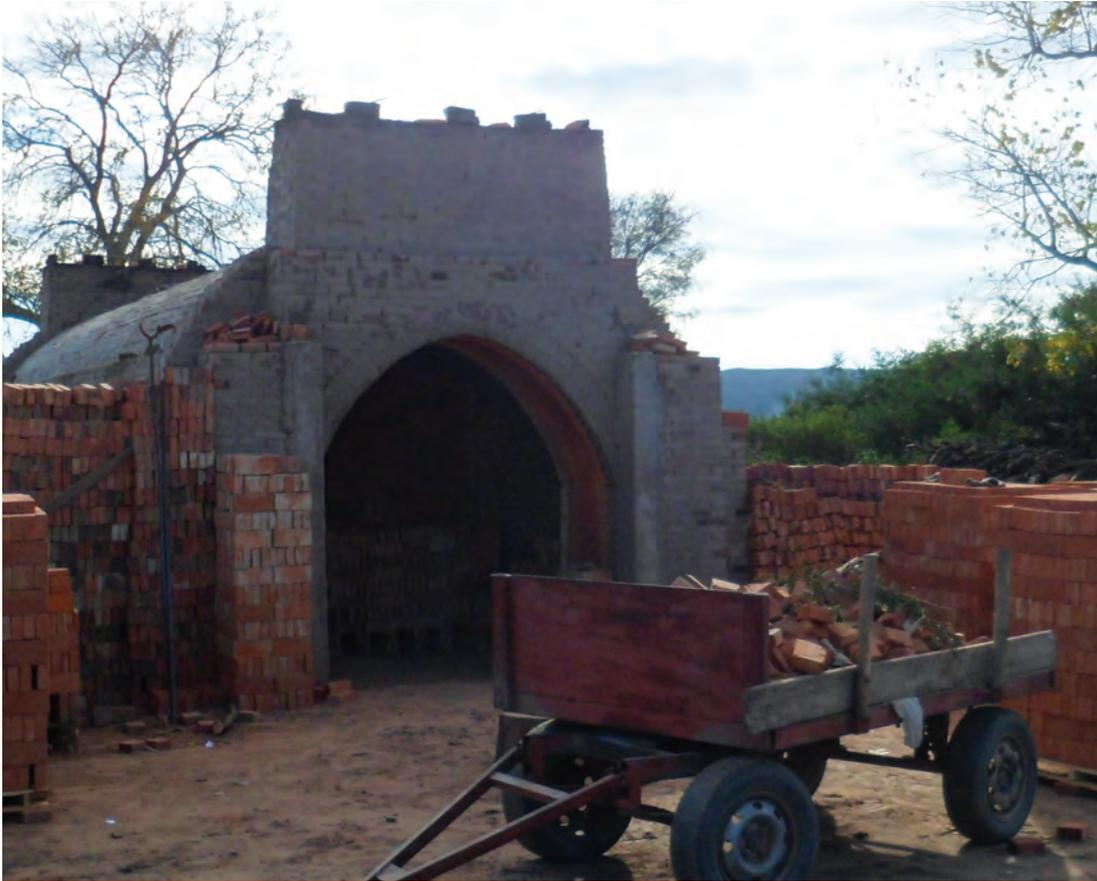
Etapa del proceso productivo: clasificación y apilado en pallets de ladrillos fuera del horno. (Traslasierra, Córdoba).
